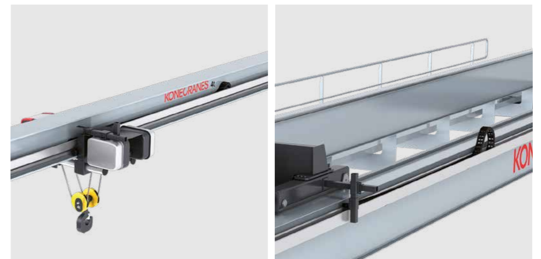
Energiaketju suojaa virta- ja ohjauskaapeleita mekaaniselta kulumiselta.
