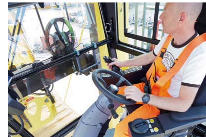
Ein Cockpit, in dem Fahrer gerne Platz nehmen: verstellbare Lenksäule, auf Wunsch elektrisch rotierender Fahrersitz, flexibel justierbare Pedale
